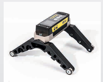
Pieds pour mesures sur surfaces cylindriques avec diamètres supérieurs à 55 mm. Accessoire optionnel – Réf. 12-0901.
